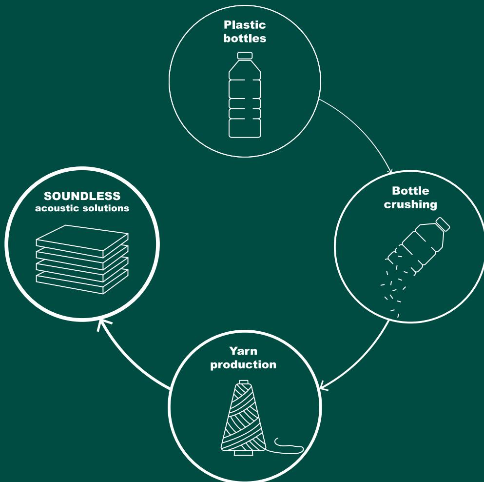
O FELTPET é obtido através de garrafas de plástico recicladas, prolongando o seu ciclo de vida . Este processo é constituído por cinco etapas: Separação e Classificação, Granulação, Extrusão, Feltragem e por último o Painel Acústico.
